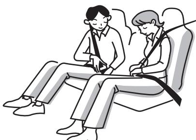
차량에 프리텐셔너가 장착된 안전 벨트와 SRS (보조 안전 장치) 에어백 시스템이 장착되어 있을 경우 일정 수준을 넘는 전방 충격이 발생하면 프리텐셔너 장착 안전 벨트와 에어백이 운전자와 조수석 승객을 좌석에 확실히 고정하고 머리에 물리적으로 가해지는 충격을 줄여줍니다(차량의 운전석과 조수석 모두 에어백이 장착되어 있을 경우).
