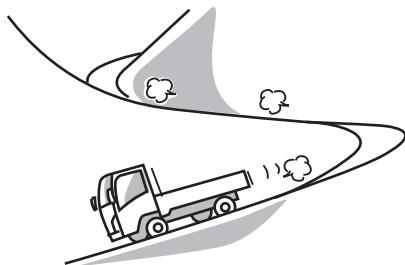
긴 내리막길을 주행할 때는 풋 브레이크와 함께 엔진 브레이크와 보조 브레이크를 사용하십시오. 보조 브레이크와 저단 기어 엔진 브레이크를 사용하면 풋 브레이크의 작동 부하가 줄어들고 더 큰 제동력을 얻을 수 있습니다. 그래도 엔진이 과도하게 회전하는 것을 방지하기 위해 적절히 풋 브레이크를 사용하십시오.
