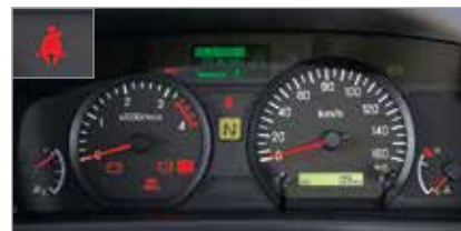
시인성이 우수한 계기판 (조수석 시트벨트 리마인더: 경고음/시그널 장치)
